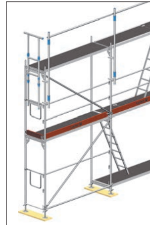
Bild 23: Aufbau Stirn-MSG
