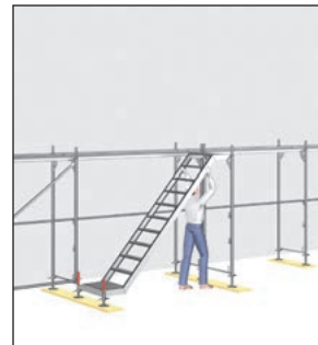
Bild 64: Einhängen der Podesttreppe
