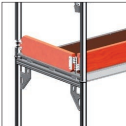
Bild 35: Bordbretteinhängung
