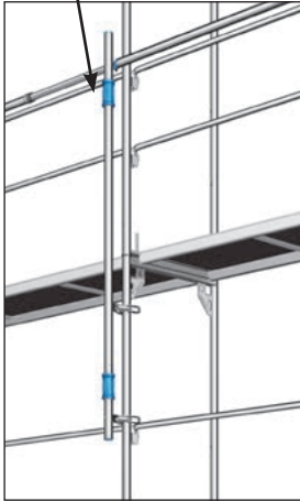
Bild 21 und 22: Anschluss des Montagepfostens an einen Blitz-Stellrahmen
