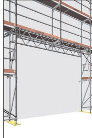
Bild 97: Gitterträgerüberbrückung
