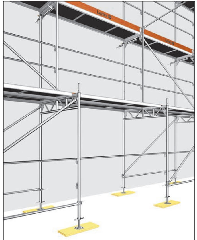
Bild 105: Einbau Durchgangsrahmen
