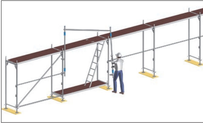
Bild 25: Montage des MSG im Aufstiegsfeld
